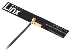
A **dipolo:** un'antenna, solitamente con lunghezza d'onda  $1/2$ , divisa esattamente al centro per essere collegata a una linea di alimentazione.
